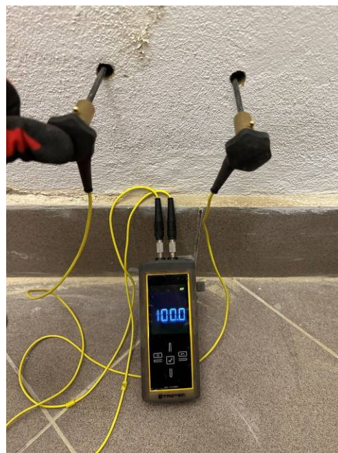
Fotografia nr. 32 Widoczne pomiary wgłębne. Urządzenie pokazuje maksymalne zawilgocenie na wyświetlaczu (wartość 100).
