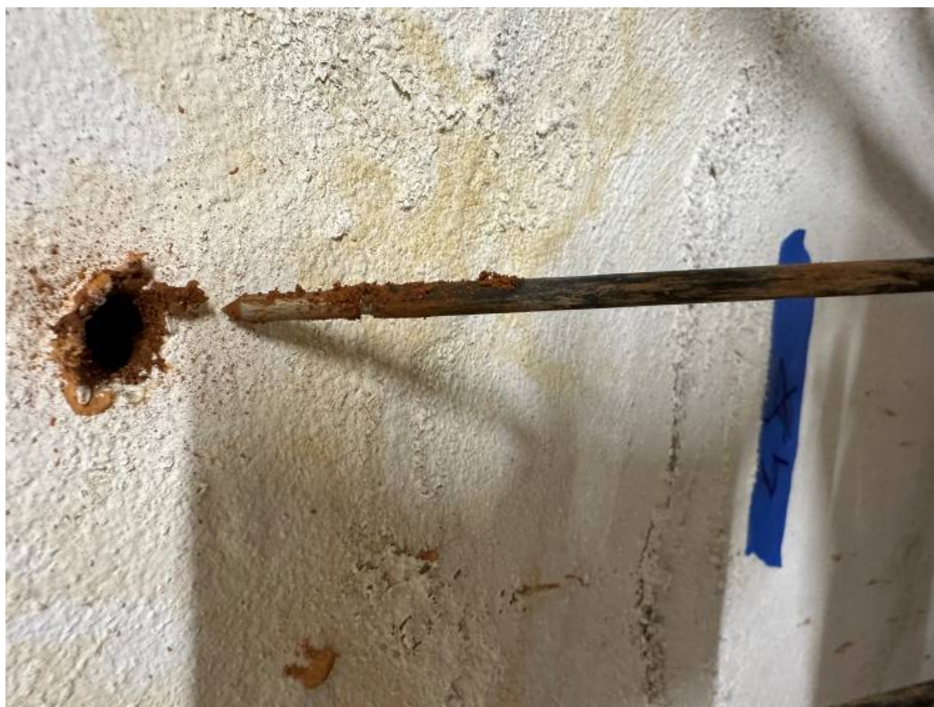
Fotografia nr. 31 Zdjęcie prezentuje faktyczny stopień zawilgocenia cegły w miejscach badawczych. Na elektrodach widoczne zwierciny w stanie pełnego zawilgocenia przyjmujące postać lepkiej masy.
