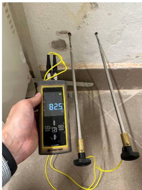
Fotografia nr. 32 Widoczne pomiary wgłębne. Urządzenie pokazuje maksymalne zawilgocenie na wyświetlaczu (wartość 100).
