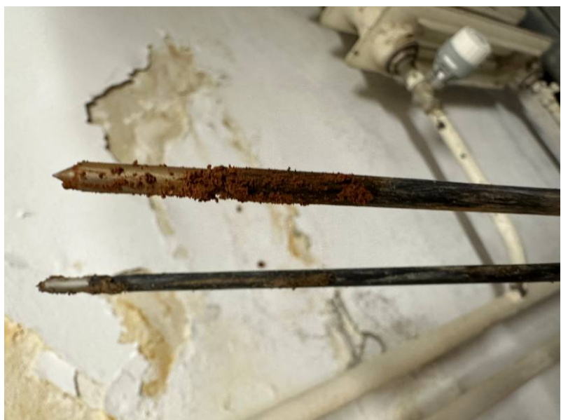
Fotografia nr. 30 Zdjęcie prezentuje faktyczny stopień zawilgocenia cegły w miejscach badawczych. Na elektrodach widoczne zwierciny w stanie pełnego zawilgocenia przyjmujące postać lepkiej masy.
